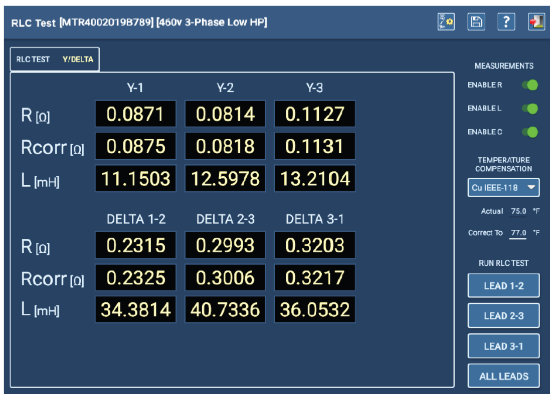
Rys. 45: Pomiary RLC w trybie ręcznym – przetworzone wyniki prezentowane w zakładce Y/DELTA
