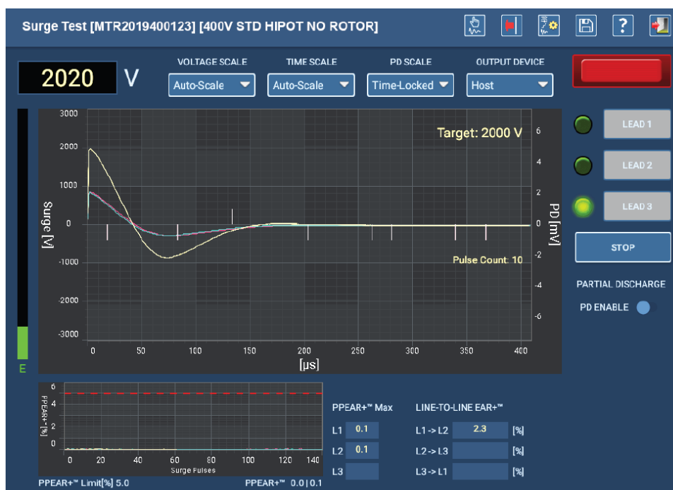
Rys. 60: Ekran automatycznych testów udarowych w czasie trwania pomiaru
