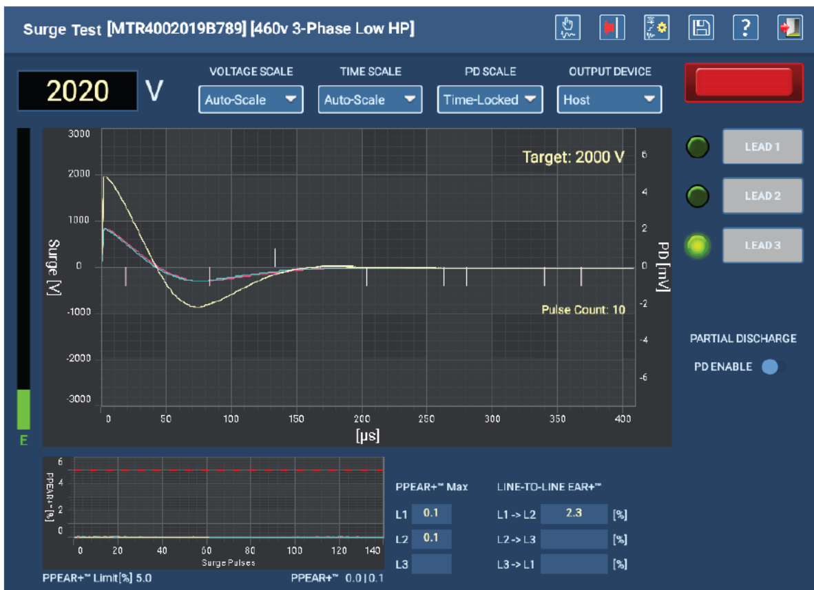
Rys. 51: Ekran podczas trwania ręcznego testu udarowego
