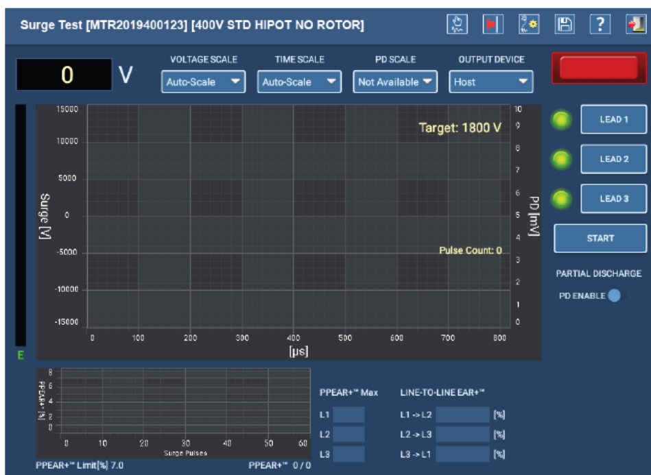
Rys. 59: Ekran początkowy automatycznych testów udarowych
