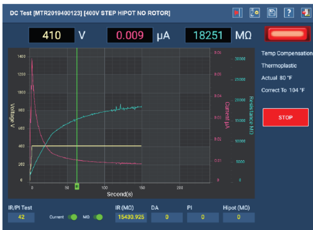
Rys. 64: Ekran trwającej automatycznej próby napięciowej w sekwencji pomiarów
