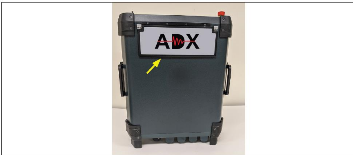
Rys. 31: Ustawienie analizatora pionowo na tylnych stopkach
