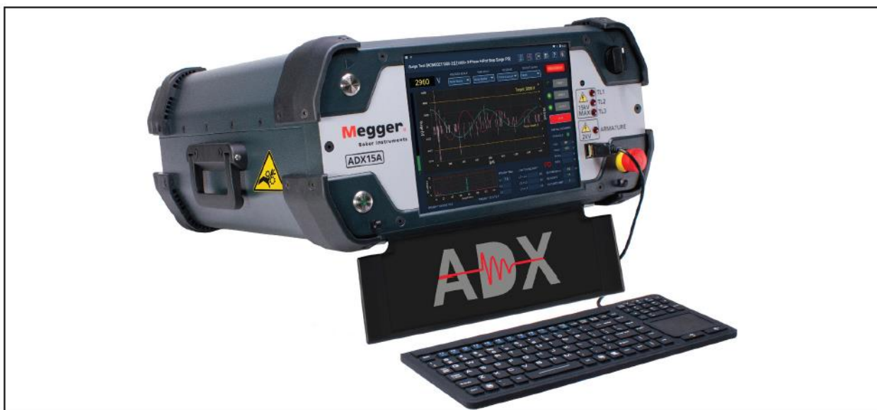
Rys. 32: Przyrząd oparty na rozłożonej podpórcie – możliwość obserwacji ekranu pod dogodniejszym kątem
