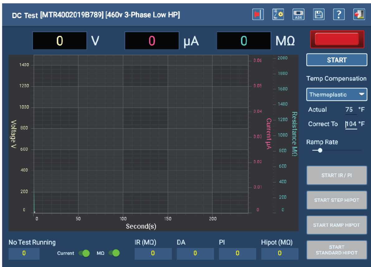
Rys. 46: Ekran główny ręcznych pomiarów rezystancji izolacji i prób napięciowych DC
