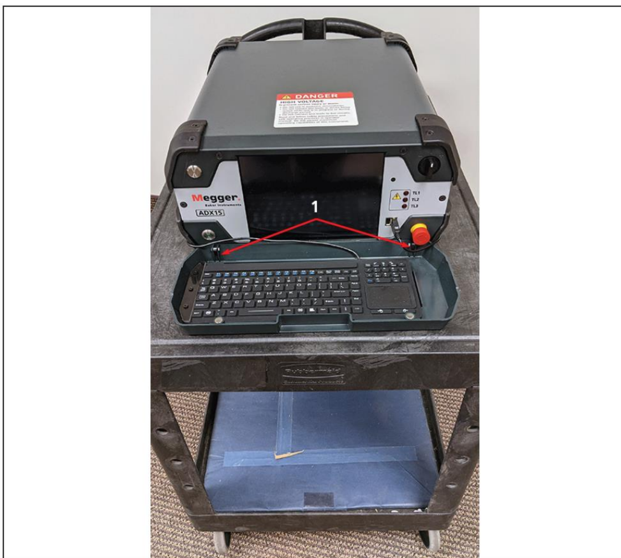
Rys. 30: Analizator ADX stojący na wózku warsztatowym – wszystkie stopki przyrządu mają pełen kontakt z powierzchnią roboczą; kółka wózka są zablokowane.
