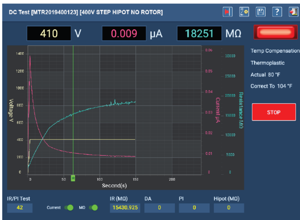
Rys. 58: Ekran automatycznej próby napięciowej
