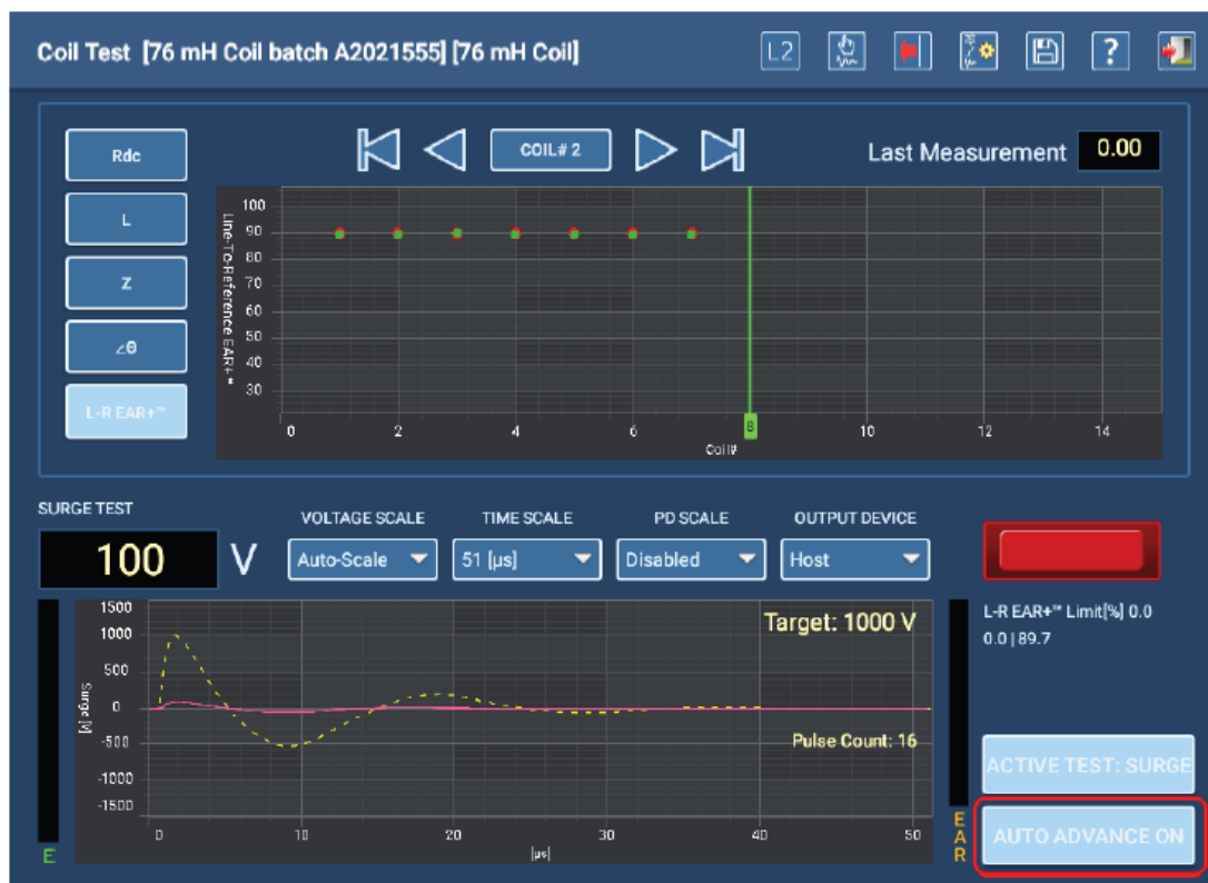
Rys. 53: Ekran pomiarów cewek z przykładowym pomiarem w toku
