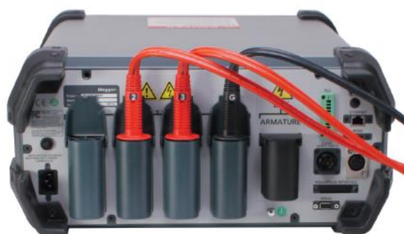
Rys. 3: Przed podłączeniem przewodów pomiarowych sprawdź stan techniczny gniazd i przewodów
