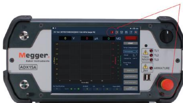
Rys. 2: Wyłącznik awaryjny na płycie czołowej analizatora ADX
