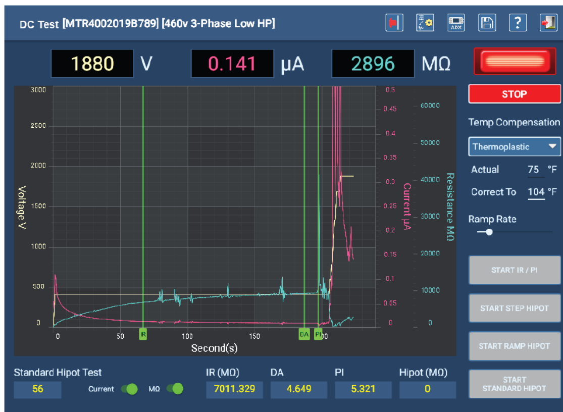
Rys. 48: Widok ekranu podczas standardowej próby napięciowej
