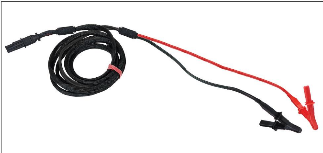
Rys. 13: Chwytaki pomiarowe ADX-ASC do testów udarowych uzwojeń twornika
