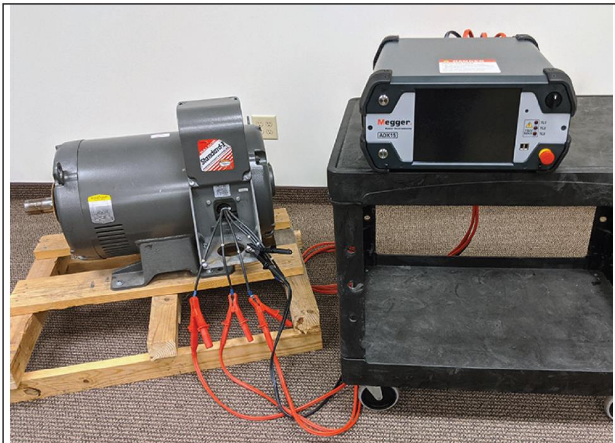
Rys. 35: Prawidłowe odseparowanie i prowadzenie przewodów pomiarowych podłączonych do przewodów obiektu pomiaru
